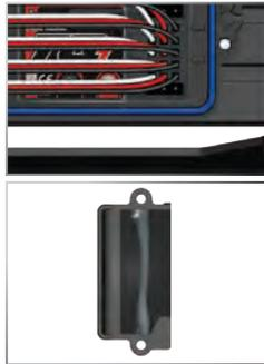
5. Instale la sujeción del cable y ajuste bien los dos tornillos de 2,5 x 8 mm.
