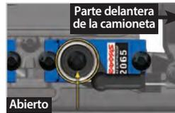
**Diferenciales bloqueados:** Encienda el transmisor y el receptor. Mueva el interruptor T-Lock a su posición media para bloquear el diferencial delantero. Confirme que el eje de salida del servo gira en sentido contrario a las agujas del reloj para girar la bocina del servo hasta la posición que se muestra.
