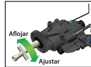
Para restablecer los ajustes de fábrica, utilice la llave cruz incluida para girar la tuerca de ajuste hasta que las cuatro arandelas elásticas estén planas; luego, apriete la tuerca 1/16 de giro adicional (o hasta que el embrague deslizante no permita que el engranaje recto se deslice durante el funcionamiento normal).
