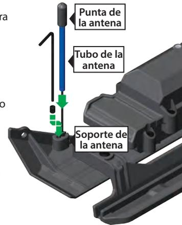
**!** Para evitar la pérdida de rango de la radio, no retuerza ni corte el cable negro, no doble ni corte la punta de metal y no doble ni corte el cable blanco que se encuentra en el extremo de la punta de metal.
