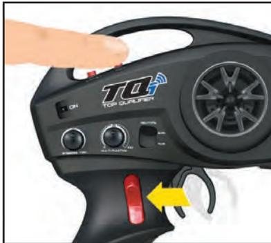
Para que coincida exactamente con su ritmo, puede equilibrar la velocidad ajustando el mando multifunción del transmisor. Gire la perilla hacia la derecha para aumentar la velocidad, o hacia la izquierda para reducir la velocidad. Puede acelerar y conducir más rápido con el juego de control de cruceo, y el vehículo reanudará la velocidad ajustada cuando se suelte el acelerador (Función de reanudación).
