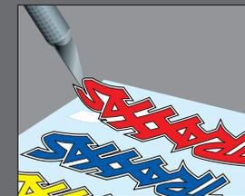
Para aplicar las calcomanías, coloque un extremo hacia abajo, sostenga el otro extremo arriba y deslice el dedo lentamente a medida que avanza. Esto evitará que se formen burbujas de aire. Si coloca los dos extremos de la calcomanía hacia abajo y luego intenta deslizar el dedo, se producirán burbujas de aire. Observe las imágenes en el recuadro para ver una típica colocación de calcomanías.
