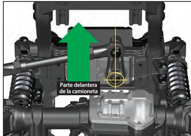
Si está utilizando servos de recambio, es importante usar bocinas de servos diseñadas para TRX-4. Las bocinas del servo deben medir 22 mm desde el orificio de montaje del varillaje de la dirección hasta el orificio de montaje del servo.
