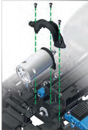
Para ajustar la rueda dentada, use el cuadro de la izquierda para identificar las posiciones del tornillo en la placa del motor (A - H) que corresponden con el tamaño del engranaje de piñón del motor (9-T - 22-T) y el engranaje recto elegido (39-T o 45-T). Extraiga los dos tornillos del motor o la placa del motor y vuelva a instalar en las posiciones correspondientes. Vuelva a instalar el motor o ensamblaje de la placa del motor en el chasis.
