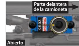
**Diferenciales bloqueados:** Encienda el transmisor y el receptor. Mueva el interruptor T-Lock hasta la posición más adelante para bloquear el diferencial trasero. Confirme que el eje de salida del servo gira en sentido contrario a las agujas del reloj para girar la bocina del servo hasta la posición que se muestra.
