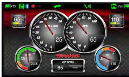
El tablero de instrumentos personalizado de Traxxas Link proporciona datos del rpm, la velocidad, la temperatura y el voltaje en tiempo real.
